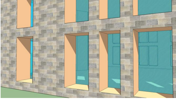
Şekil 8. Tarihi camilerdeki taş duvarlar kalınlığı.
